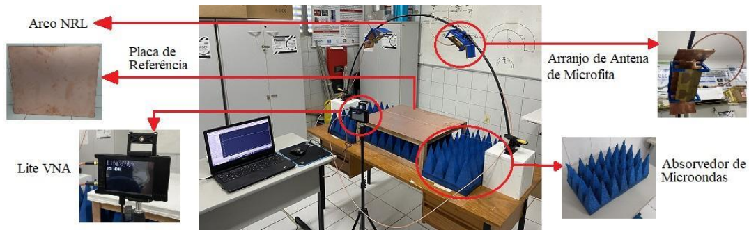
Figura 1 – Setup de medição de refletividade proposto.
