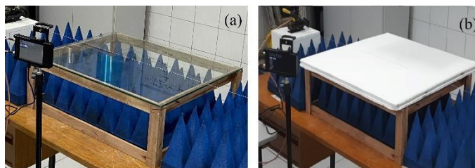
Figura 2 – Materiais no arco para caracterização. (a) Vidro; (b) Placa de gesso.
